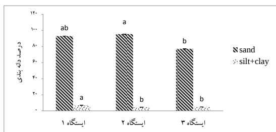
شکل ۴: مقایسه درصد دانه بندی بافت بستر در ایستگاههای مختلف در رودخانه کرگانرود
