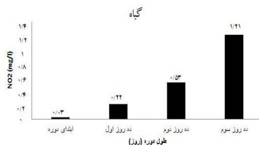
شکل ۲: روند تغییرات غلظت نیتريت (mg/lit) با استفاده از گیاه چنگال آبی طی ۳۰ روز آزمایش
