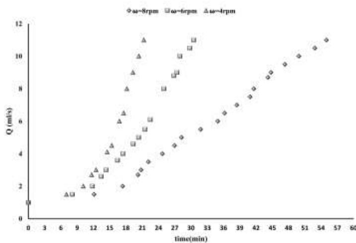
شکل ۳‌الف: نمودار افت-زمان برای دبی ورودی ۵۵۰ میلی‌لیتر بر ثانیه (سطح غرقابی ۱۵ درصد و غلظت ۳۰ میلی‌گرم بر لیتر) در سرعت‌های چرخشی ۸ دوربردقيقة (SEM=۰.۰۵۱)، ۶ دوربردقيقة (SEM=۰.۰۶) و ۴ دوربردقيقة (SEM=۰.۰۵۸).
