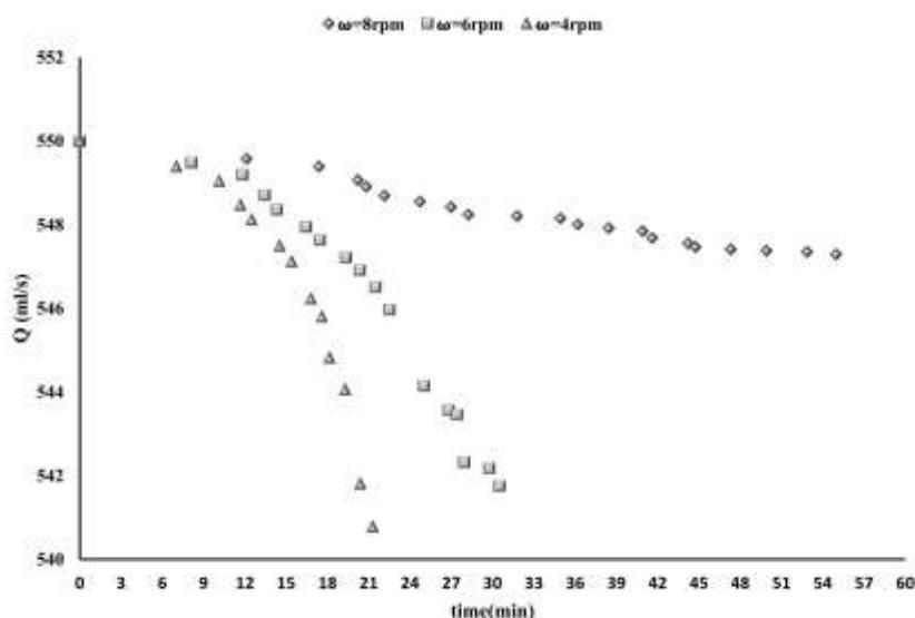
شکل ۳‌ب: نمودار دبی-زمان برای دبی ورودی ۵۵۰ میلی‌لیتر بر ثانیه (سطح غرقابی ۱۵ درصد و غلظت ۳۰ میلی‌گرم بر لیتر) در سرعت‌های چرخشی ۸ دوربردقيقة (SEM=۰.۰۵۱)، ۶ دوربردقيقة (SEM=۰.۰۶) و ۴ دوربردقيقة (SEM=۰.۰۵۸).
