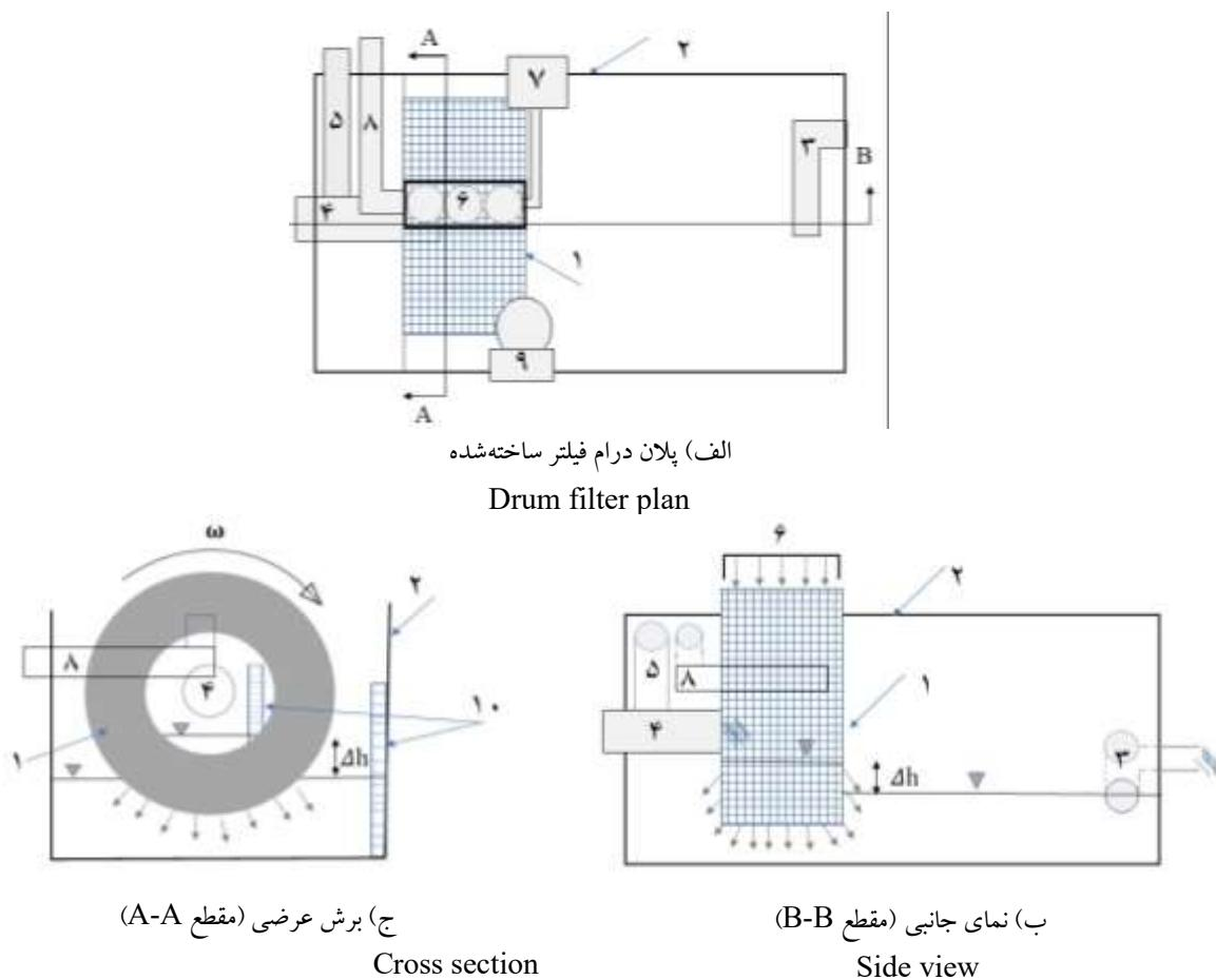
شکل ۲: شماتیک درام فیلتر ساخته شده در مقیاس آزمایشگاهی. (۱- استوانه چرخان پوشیده شده با اسکرین ۲- مخزن (وان) ۳- لوله تنظیم کننده آب خروجی ۴- لوله ورودی آب تمیز ۵- لوله ورودی پساب ۶- نازل های شست و شو ۷- پمپ شست و شو ۸- سینی انتقال ذرات شسته شده از درام به بیرون ۹- موتور درام و تنظیم کننده سرعت ۱۰- خط کش اندازه گیری سطح آب در داخل و خارج درام)
