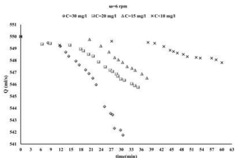
شکل ۴‌ب: مقایسه نمودارهای دبی-زمان در غلظت‌های ۱۰ (SEM=۰.۰۷)، ۱۵ (SEM=۰.۰۶)، ۲۰ (SEM=۰.۰۶)، و ۳۰ (SEM=۰.۰۸) میلی‌گرم‌لیتر برای دبی ورودی ۵۵۰ میلی‌لیتر بر ثانیه در سرعت ۶ دور بر دقیقه (سطح غرقابی ۱۵ درصد)
