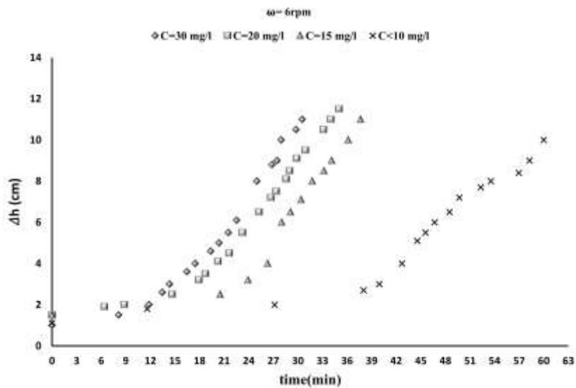
شکل ۴‌الف: مقایسه نمودارهای افت-زمان در غلظت‌های ۱۰ (SEM=۰.۰۷)، ۱۵ (SEM=۰.۰۶)، ۲۰ (SEM=۰.۰۶)، و ۳۰ (SEM=۰.۰۸) میلی‌گرم‌لیتر برای دبی ورودی ۵۵۰ میلی‌لیتر بر ثانیه در سرعت ۶ دور بر دقیقه (سطح غرقابی ۱۵ درصد)
