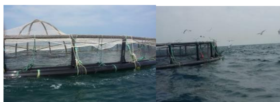
شکل ۱۲: نمایی از تجمع پرندگان دریایی در اطراف قفسهای شناور در دریای خزر و روش محافظت ماهیان از شکار آنها
